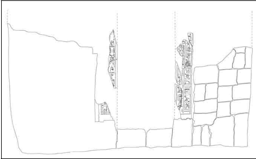
Dibujo de la fachada, con las jambas construidas en mampostería, con bloques de arenisca tallados (dibujo Ana de Diego).
